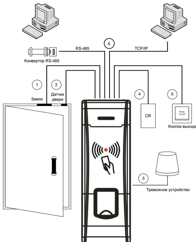
1. При проходе пользователя и успешной идентификации ST-FR030EMW разблокирует дверь.
