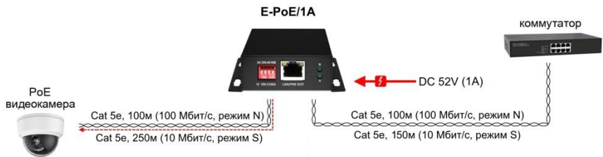
Рис.4 Схема подключения удлинителя E-PoE/1A в режиме PoE инжектора
